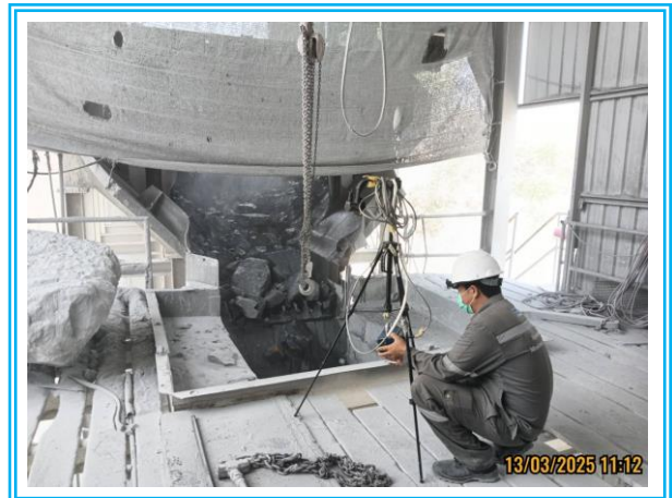
รูปที่ 4.3-11 แสดงการตรวจวัดค่าความทึบของฝุ่นละออง (Opacity) ใต้ปากโม่ (Primary Crusher) วันที่ 13 มีนาคม 2568
