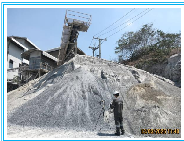
รูปที่ 4.3-14 แสดงการตรวจวัดค่าความทึบของฝุ่นละออง (Opacity) จุดถ่ายโอน (Transfer Point) วันที่ 13 มีนาคม 2568
