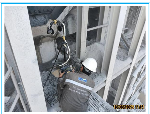
รูปที่ 4.3-12 แสดงการตรวจวัดค่าความทึบของฝุ่นละออง (Opacity) บนเครื่องย่อยที่ 2 (Secondary Crusher) วันที่ 13 มีนาคม 2568
