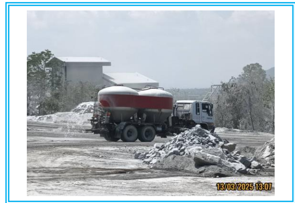
รูปที่ 2.8-2 ฉีดพรมน้ำตามเส้นทางขนส่งแร่ภายในโครงการ
