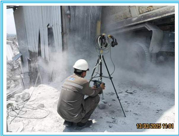
รูปที่ 4.3-10 แสดงการตรวจวัดค่าความทึบของฝุ่นละออง (Opacity) บนปากโม่ (Primary Crusher) วันที่ 13 มีนาคม 2568
