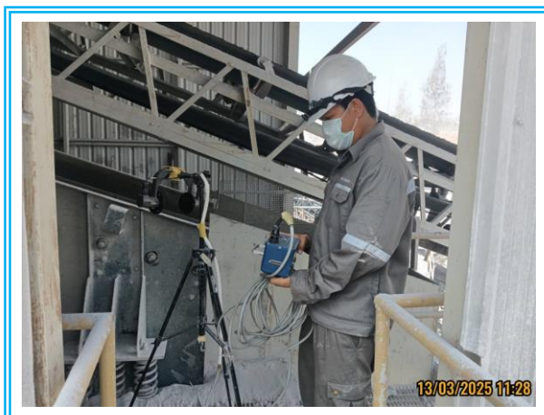
รูปที่ 4.3-13 แสดงการตรวจวัดค่าความทึบของฝุ่นละออง (Opacity) บนตะแกรงชุดที่ 1 (Screen No.1) วันที่ 13 มีนาคม 2568
